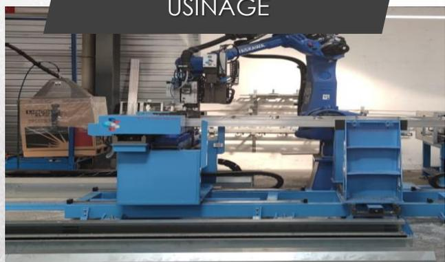
Les angles des panneaux sont alors tous usinés pour une meilleure précision et finition, puis les douilles de passage de tiges sont insérées. Ces étapes sont également automatisées.
